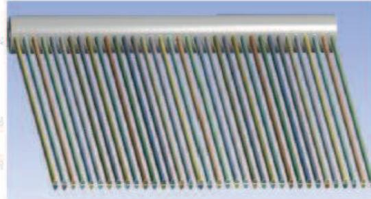
Figura 2: Geometría colector solar 36 tubos
