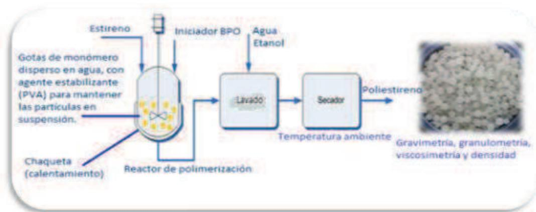
**Figura 1** Montaje general. Polimerización en Suspensión
