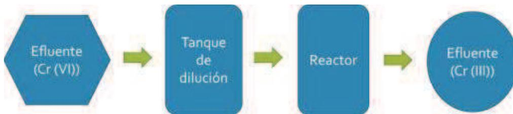
**Figura 1.** Proceso de reducción de Cr(VI) a Cr(III) de un efluente contaminado
