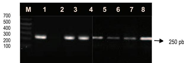
**Figura 4.** Amplificación de gen *aig*. Se corrió en un gel de agarosa al 1.5%. 1-Axénica (HM1), 2-Monoxénica(HM1), 3- 100% suero(UG10), 4-80% suero(UG10), 5-Polixénica, 6-Reaxénisada, 7- 60%suero, 8- 60%peptona, M-Marcador de tamaño en pares de bases.
