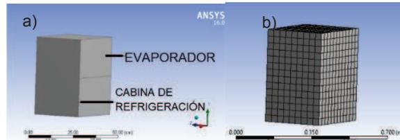
**Figura 1.** a) Geometría del Refrigerador, b) Mallado del Refrigerador
