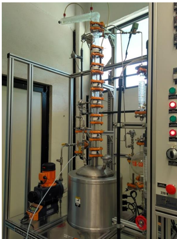
Figura 20.- Columna de destilación por lotes a escala piloto
