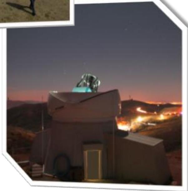
**T**iene una apertura de 1.2 metros y trabaja con un espectrógrafo tipo echelle de 20,000 de resolución. El instrumento tiene un promedio de visualización de 50 objetos por noche, con eficiencia de 90% (horas exposición / horas noche).
